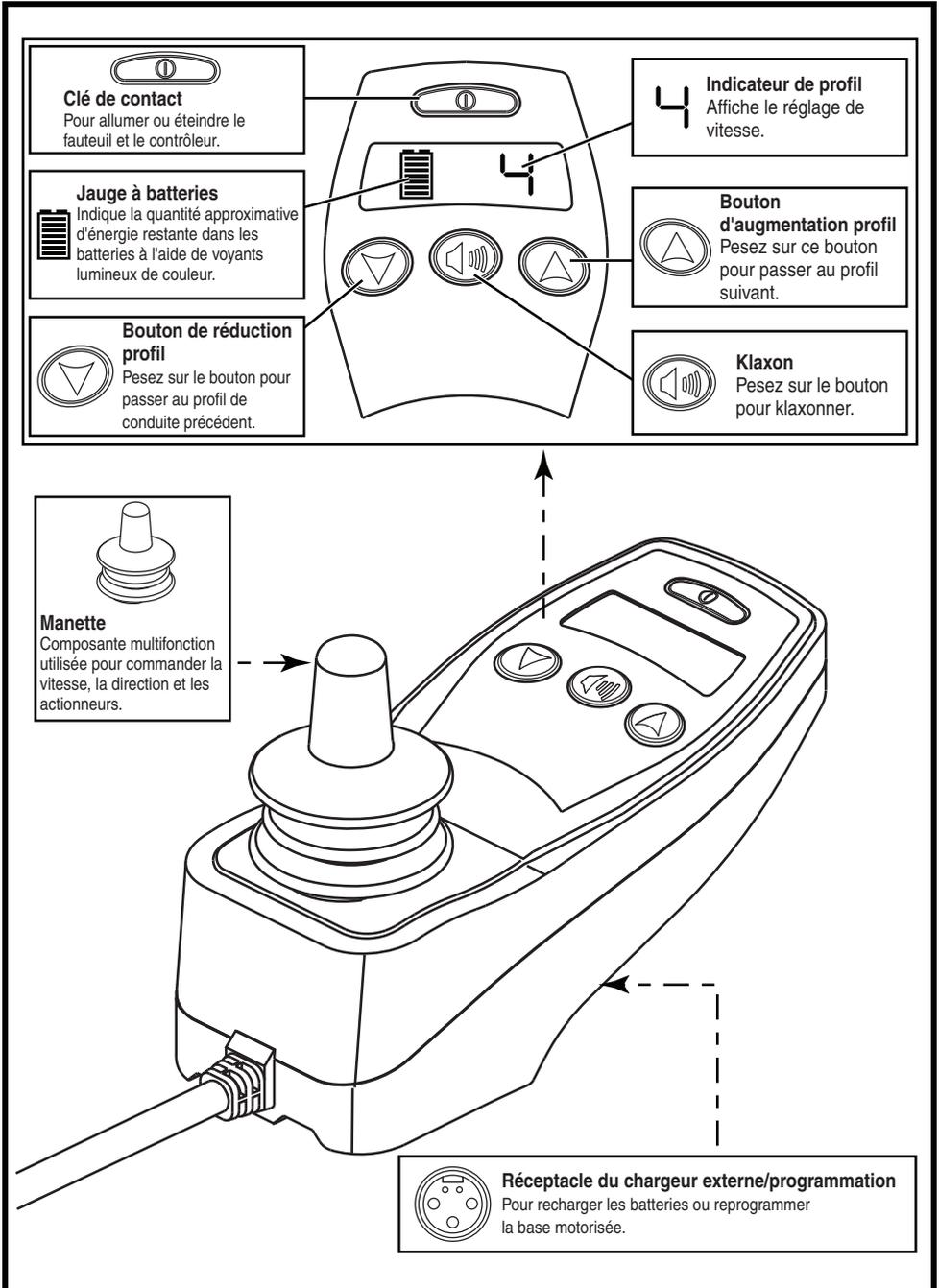
Figure 1. Composantes et connexions du contrôleur NE
